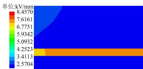
图2 c=0.9 \text{ mm} 时绝缘结构的电场分布云图
