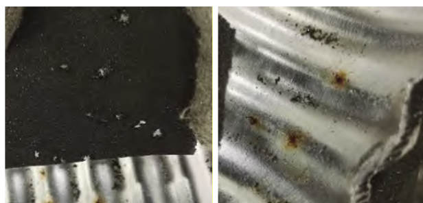
(a) 缓冲层穿孔 (b) 铝护套内表面的烧蚀痕迹
