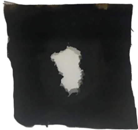
图5 破裂的聚酰亚胺织物 Fig.5 Broken polyimide fabric
