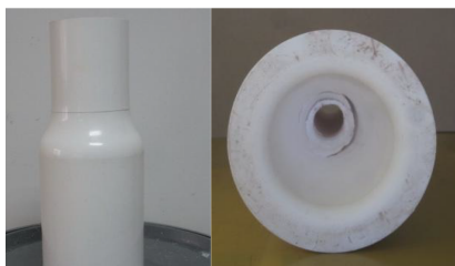
图8 异形喷口毛坯开裂部位
