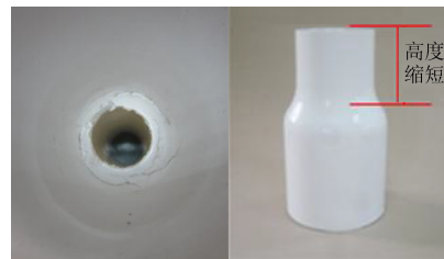
图10 优化后的喷口毛坯
