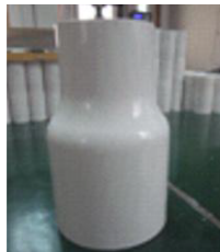
图12 优化压制工艺后的成型喷口毛坯
