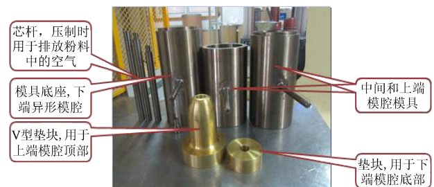
图5 近净成形异形结构压制模具实物图
