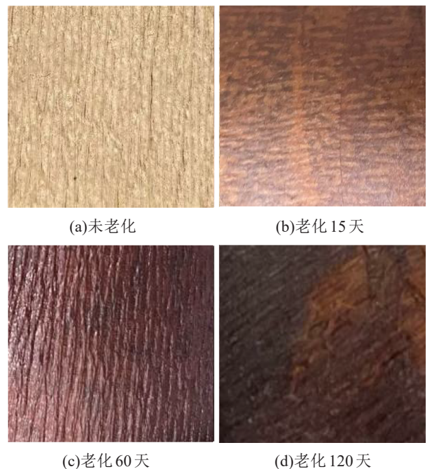
图5 不同老化阶段的油浸纸板表面形貌变化
