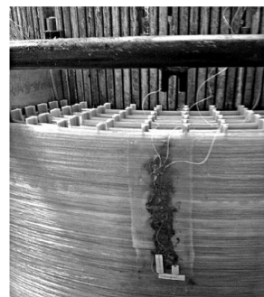
图5 埋入式光纤传感器安装位置图
