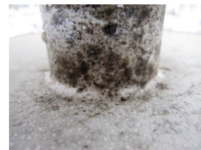
图1 霉菌污染绝缘子
