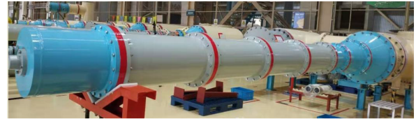
图11 盆式绝缘子雷电冲击试验
