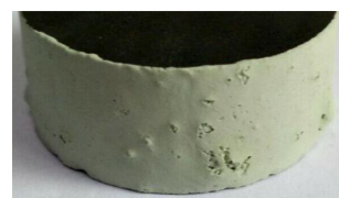
图3 采用PVA制备的釉浆施釉效果
