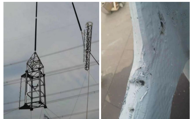
(a)试品湿操作试验 闪络路径图 (b)塔窗上绝缘横梁的 击穿闪络点
