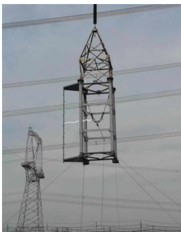
图4 雷电冲击电压试验闪络路径图
