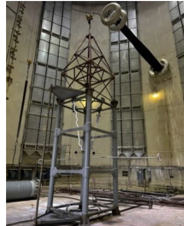
图7 人工污秽试验闪络路径图
