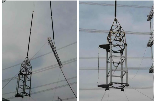
(a)雷电冲击试验样品布置 (b)湿操作冲击及湿工频耐受试验样品布置
