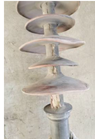
图 1 1# 酥朽复合绝缘子外观
