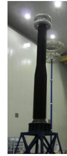
图4 空心绝缘子闪络试验布置
