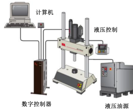
图4 力学特性测试系统
