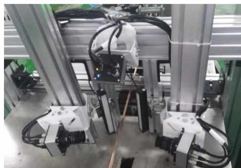
图4 视觉识别缺陷系统中的相机
