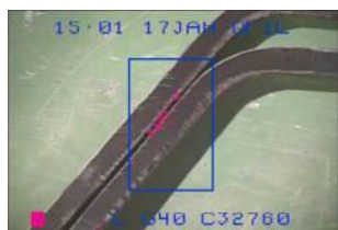
图11 同相绕组斜边紫外成像试验
