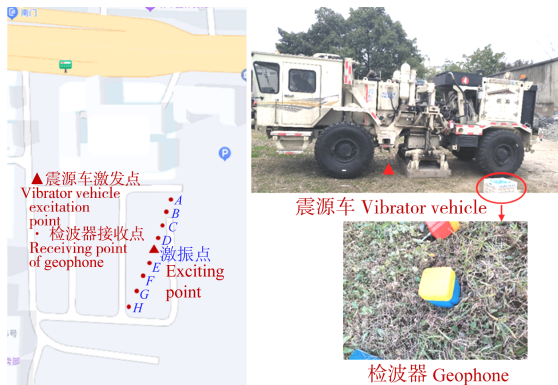
图 11 检波器布置及炮点位置示意图
