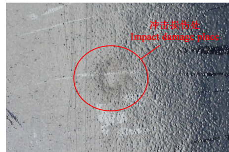
图 4 喷涂聚氨酯涂层试样的冲击损伤图 (冲击正面)
