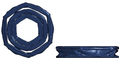
图 22 开孔多层薄壁管变形模式
