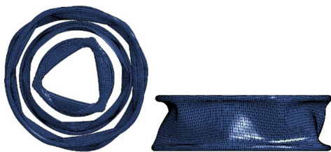
图 17 III 位置处薄壁管压溃变形
