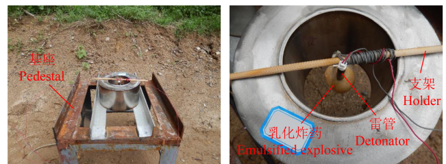
图 3 试验装置示意图
