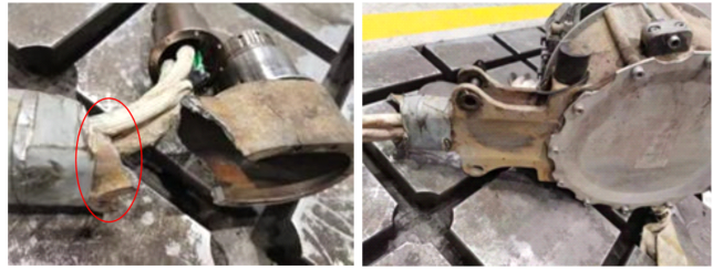
图4 实车测试过程中电机壳体断裂情况
