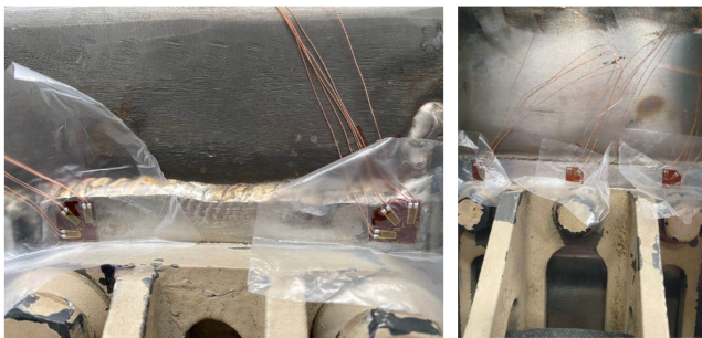
图2 实车测试中电机壳体处应变片布置情况
