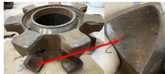
图8 磨损失效链轮
