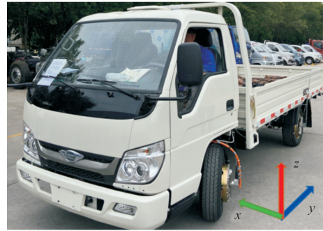
图1 道路载荷采集样车
