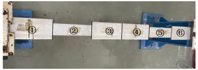
(b) 梁的刚度变化区域 (b) Variation area of beam stiffness
