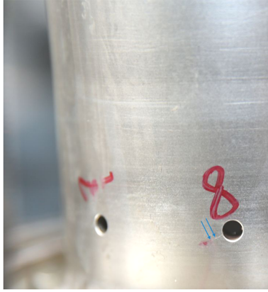
图 1 低压涡轮轴裂纹宏观形貌
