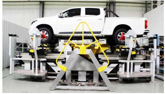
图12 悬架KC试验台架
