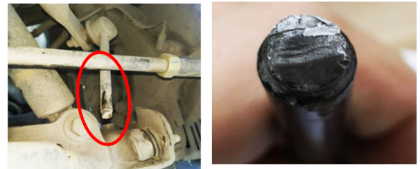
图 20 前稳定杆连杆断裂失效
