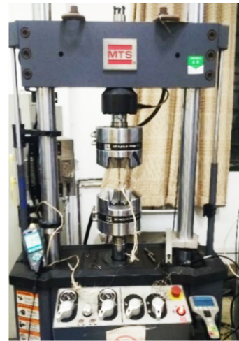
图 24 疲劳试验装置
