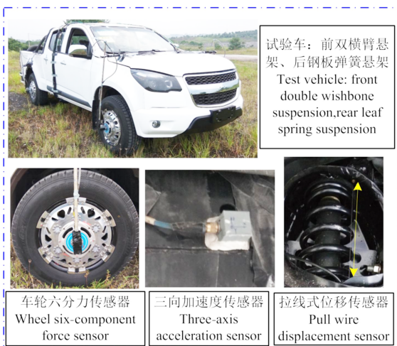
图2 试验车辆及测试传感器
