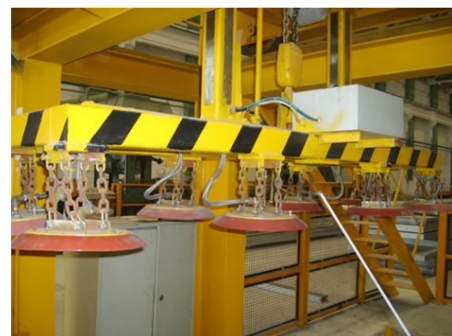
图20 船厂永磁起重抓取器
