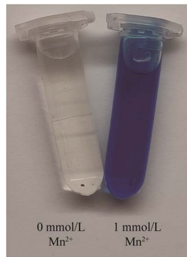
图 2 锰氧化产物的 LBB 检测结果 Fig. 2 LBB analysis of biogenic Mn 2+ oxides.
