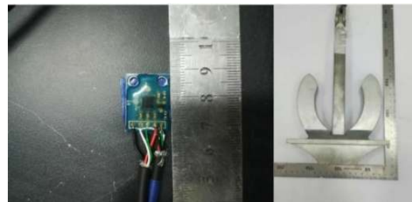
图5 MEMS 加速度传感器及其在锚上的位置 Fig. 5 MEMS accelerometer and its position on the anchor
