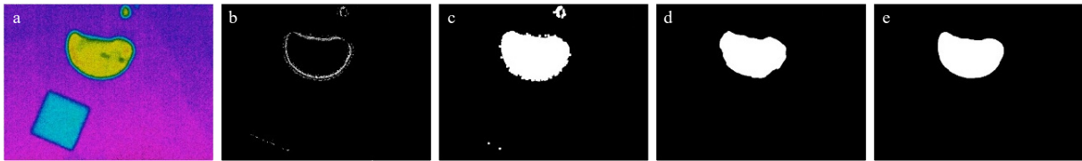
图 15 含漂浮物干扰的水槽实验条件下的 20W-50 成品油图像感兴趣的油膜区域提取结果对比
