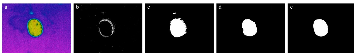
图 13 水槽实验平静水面条件下 20W-50 成品油图像感兴趣的油膜区域提取结果对比
