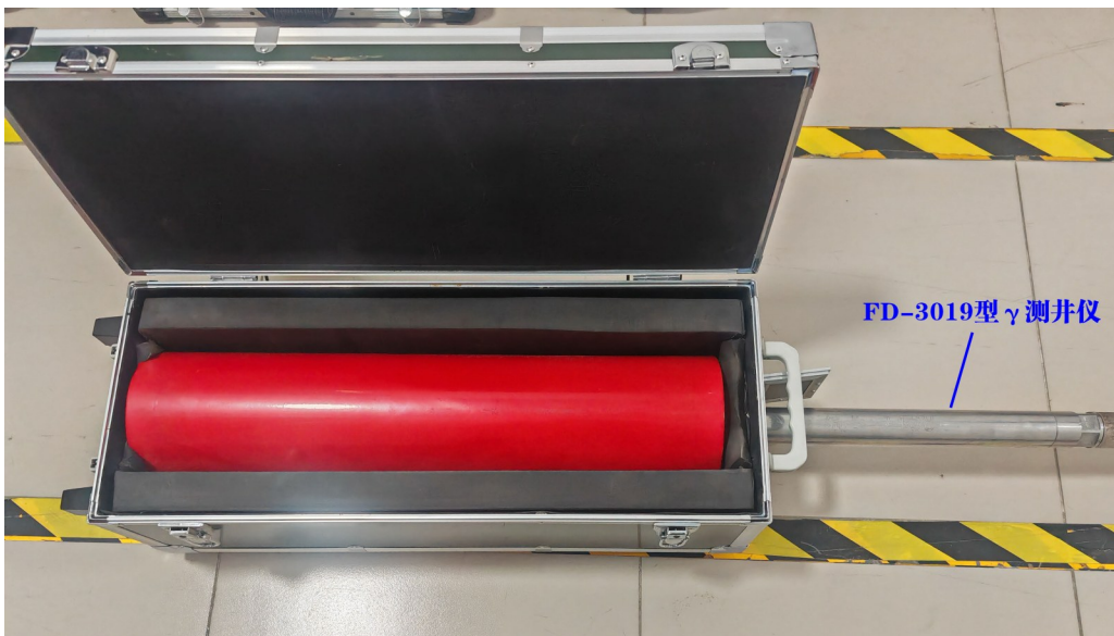
图 7 轴向辐射场分布测试
