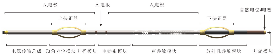
图 3 NDL461 数字综合测井仪井下模块化单元组合方式示意图
