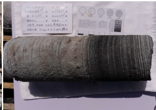
图 17 ZK350-1 灰色细砂岩(矿石) Fig. 17 ZK350-1 Gray fine sandstone(ore)
