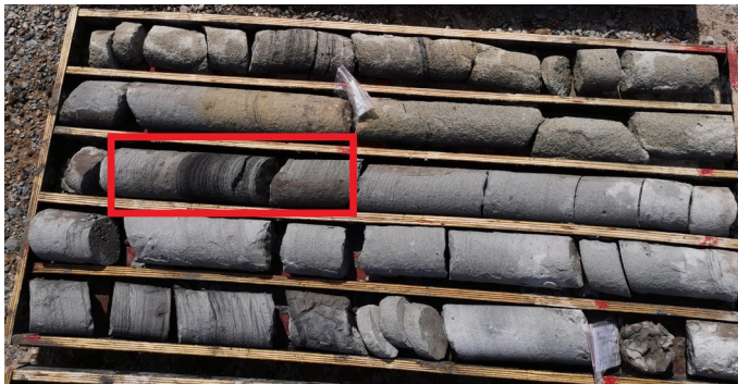
图 16 ZK350-1 层间氧化带下翼铀矿石 Fig. 16 ZK350-1 interlayer oxidation zone lower wing uranium ore
