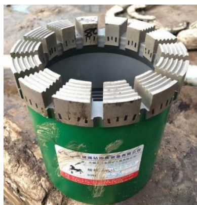
图 8 \phi 150 mm 绳索取心金刚石钻头
