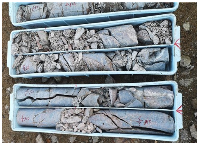
图 5 漏失地层破碎岩心
