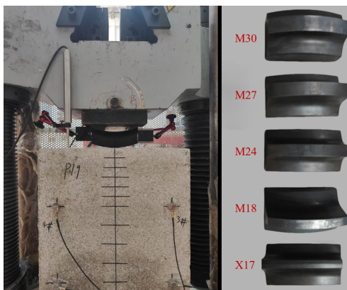
图 1 侵入试验设备及新刀、磨损刀压头
