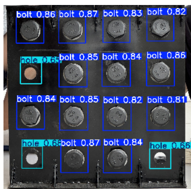
图 10 螺栓随机缺失识别
