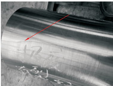
图 13 钻杆母螺纹外表面裂纹图
