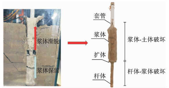
图 6 锚固系统界面滑移破坏情况
