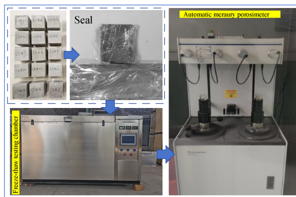
图8 冻融试验及压汞检测
