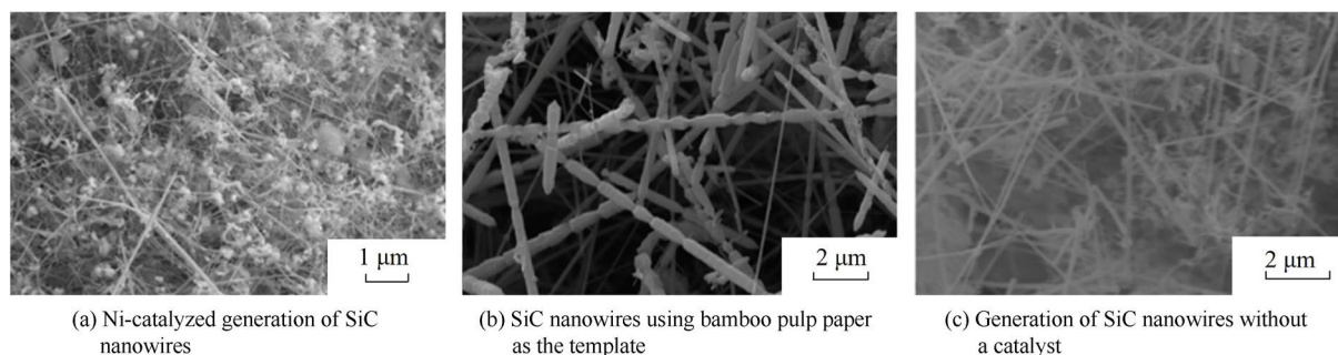
图 7 碳热还原法合成产物的微观形貌 [31, 36–37]
