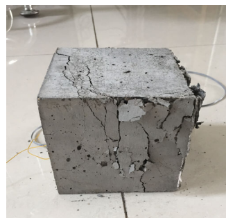
图 4 试块破坏状态
