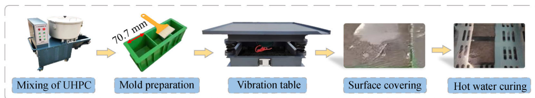
图 6 浇筑 UHPC 试件的成型与养护
