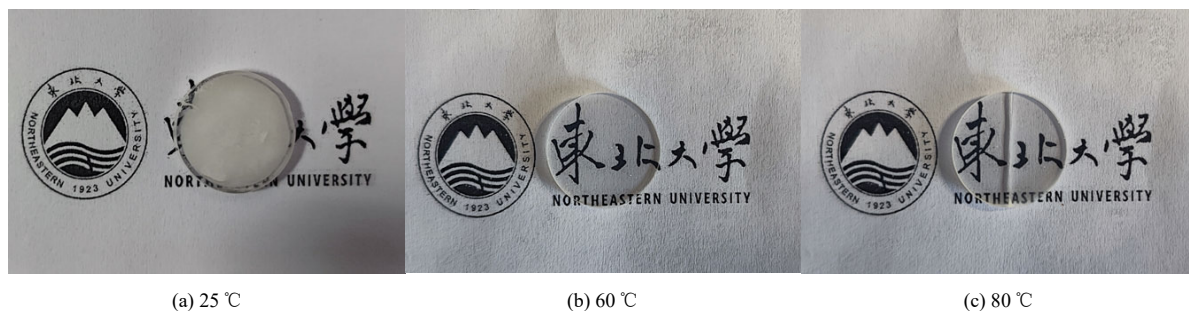
图 11 不同温度成型坯体经 1850 °C 真空烧结 6 h 制得的陶瓷实物照片
