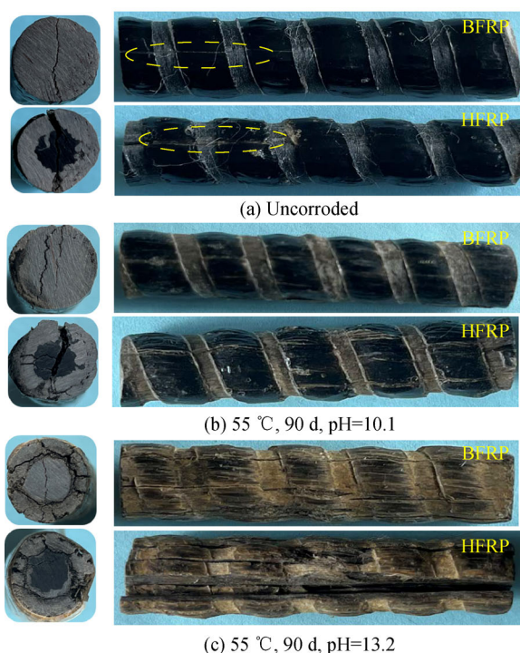
图 5 层间剪切典型失效模式 Fig. 5 Typical failure modes of interlayer shear
