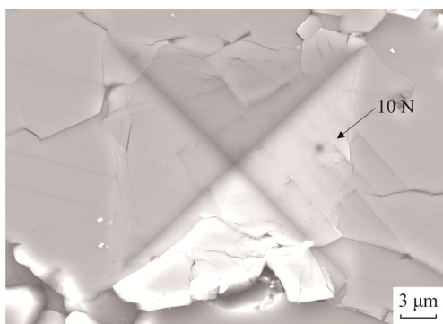
图 8 在 10 N 载荷下 \text{Al}_2\text{O}_3 陶瓷的压痕形貌
