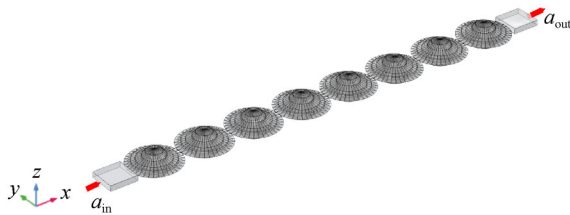
图7 衰减特性计算模型
