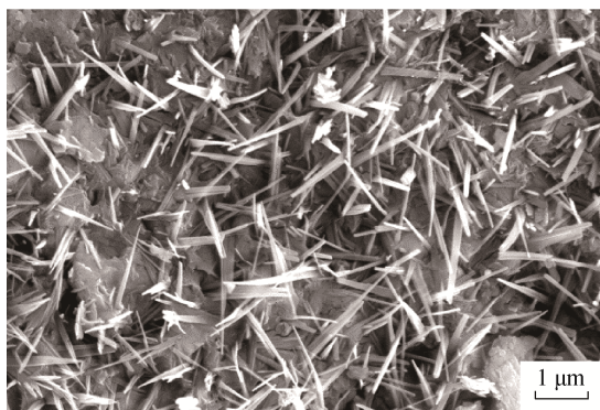
图 3 优选碱式硫酸镁水泥基加固剂水化产物微观形貌
