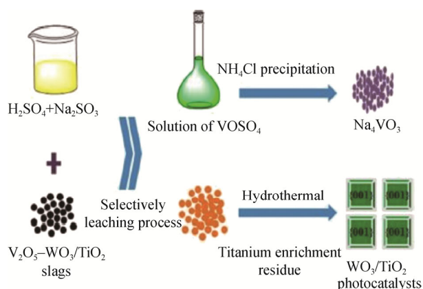
图 5 利用废弃 SCR 催化剂回收 V 并生产 \text{WO}_3\text{-TiO}_2 光催化剂的流程 [53]
