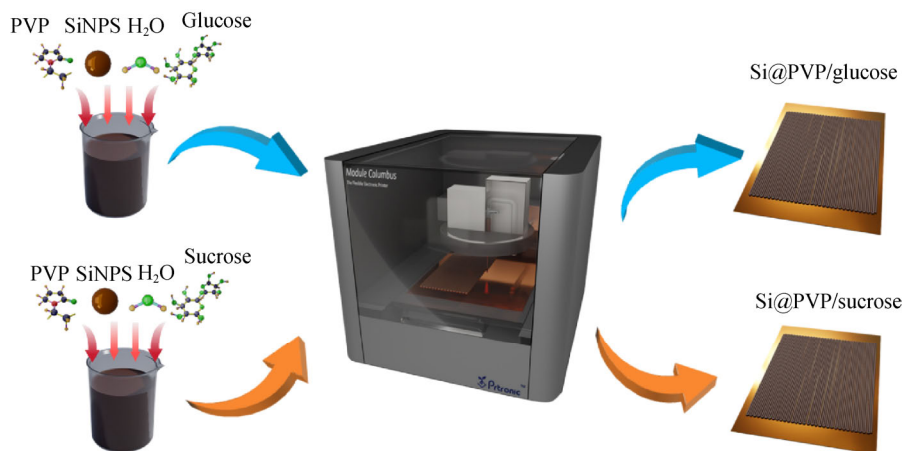
图 1 微电子打印硅基负极材料的制备流程
