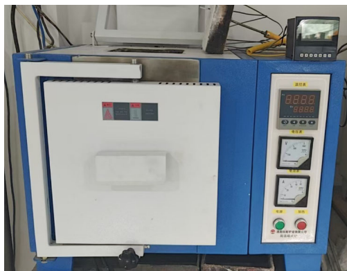
图 1 自制防火涂料耐火性能测试炉
