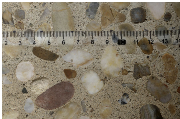
图 3 混凝土芯样侧面展开图
